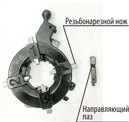
3. Вставьте выбранные ножи в пазы, следя за тем, чтобы номер на ноже соответствовал номеру, обозначенному на резьбонарезной головке. Затем вращайте кулачковый диск для установки необходимого вам размера. Нож зафиксирован.
