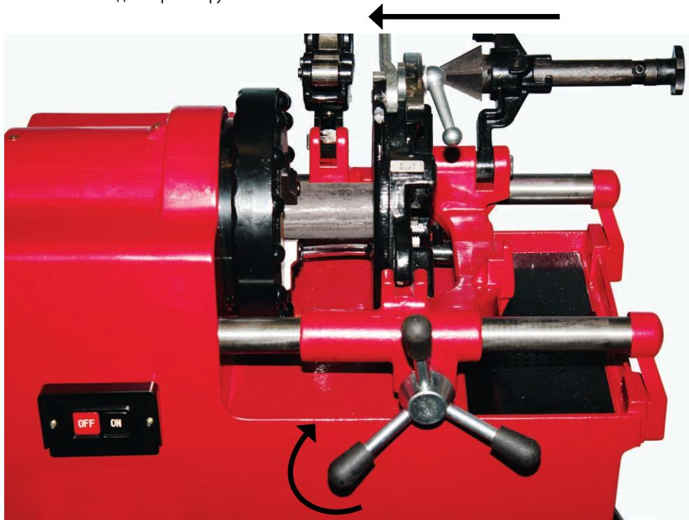
Опустите труборез на обрабатываемую деталь и включите станок выключателем.
