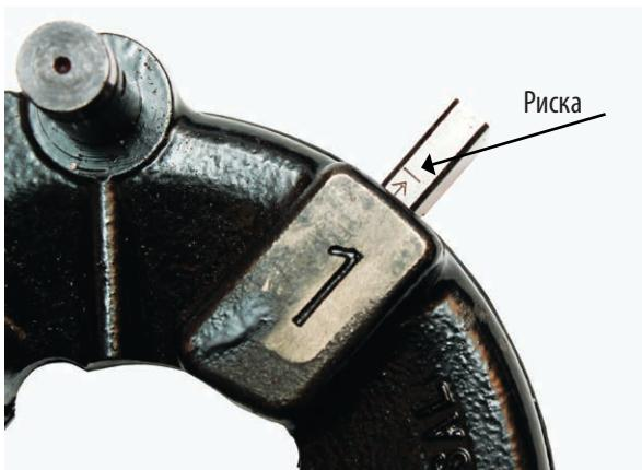
Таким же образом вставляем все ножи. Рычаг поворачиваем по часовой стрелке, фиксируем его и ставим резьбонарезную головку на место.
