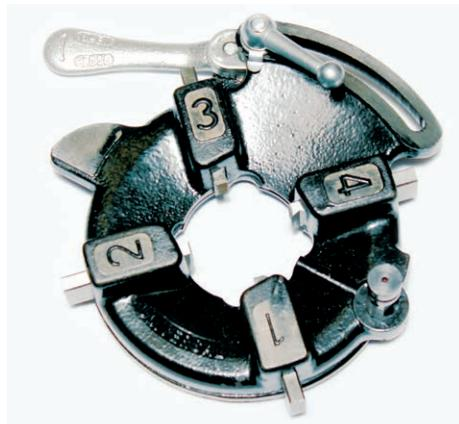
ее на горизонтальную плоскость цифрами вверх. Повернуть рукоятку потив часовой стрелки до упора. Вытащить ножи.
