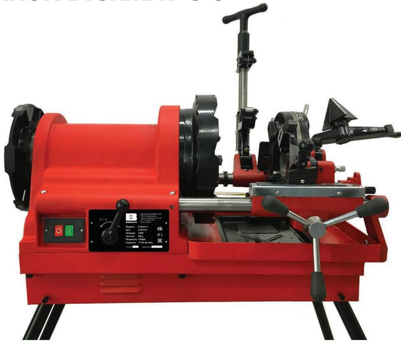
Резьбонарезной станок предназначен для нарезания наружных трубных конических (BSPT, 1/2 - 3") резьб на стальных трубах.
