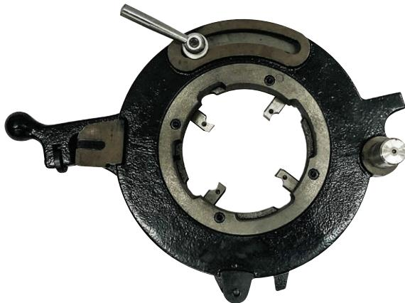
ее на горизонтальную плоскость цифрами вверх. Повернуть рукоятку против часовой стрелки до упора. Вытащить ножи.
