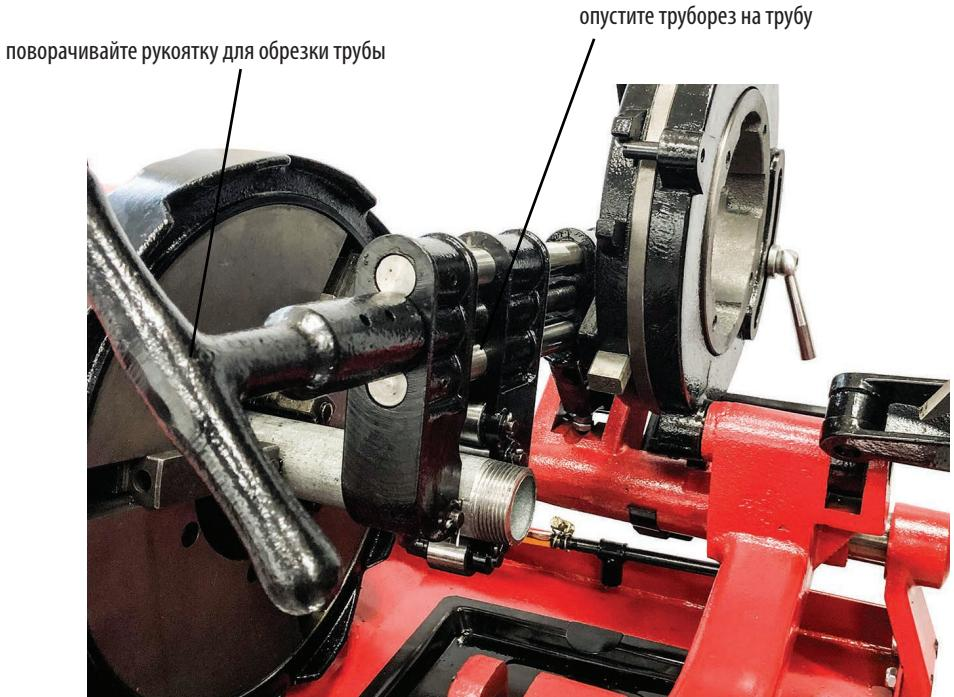
Не скапливайте обрезки труб в поддоне. Удаляйте их непосредственно после завершения процесса обрезки трубы и остановки электродвигателя станка.
