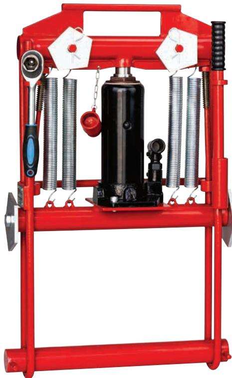
Предназначен для временного пережатия трубы ПЭ от 0 до 225 мм. Оснащен домкратом силой 12 тонн. Стопорные замки исключают потерю давления в закрытом состоянии.
