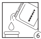
Шаг 6 - Залить теплоноситель и добавить протектор
