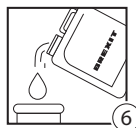
Шаг 6 - Залить теплоноситель и добавить протектор
