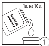
Шаг 1 - Приготовление промывочного раствора
