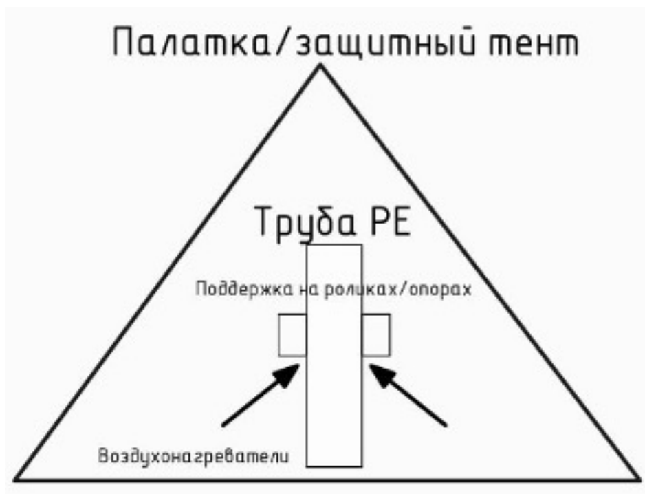
Рисунок 1 – Схема подогрева трубы
