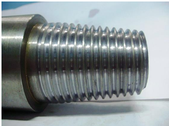
Внешний вид конической NPT резьбы
